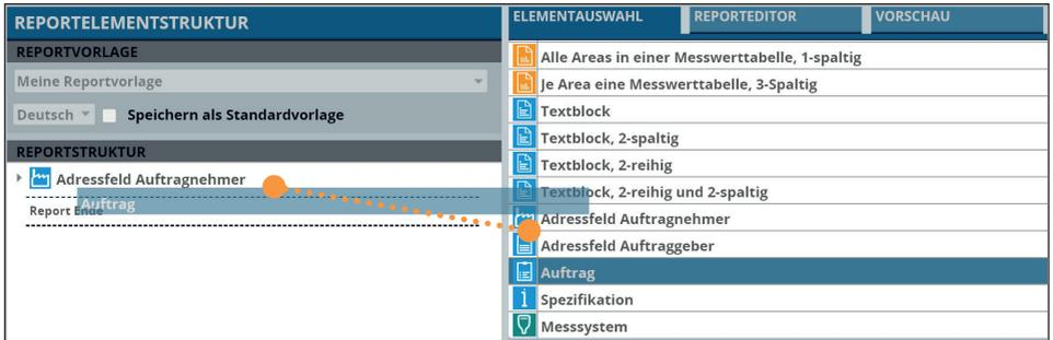
Reportelemente können in der ELEMENTSTRUKTUR nach oben oder unten verschoben werden. Elemente können gelöscht werden, indem das Elemente selektiert und der Button LÖSCHEN betätigt wird. Oder schneller: Man zieht das Element mit „Drag-and-drop“ aus dem Bereich der „REPORTSTRUKTUR“ und lässt die Maustaste los. Das Element ist gelöscht. Es gibt viele Reportelemente, deren „ELEMENTTITEL“ (Überschriften) geändert werden können. Hier ein Beispiel für das Element „Auftrag“:
