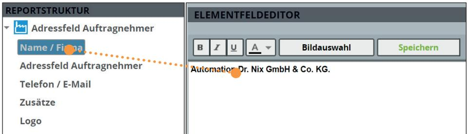
Eine Änderung muss immer mit Speichern im Editor abgeschlossen werden – Ausnahme: Bildauswahl für das Importieren von Bildern.
