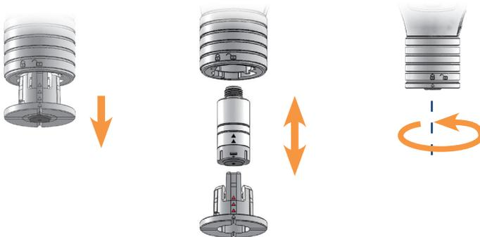
Sondenhalter bzw. Sondenkabel aus der Sondenaufnahme entnehmen
